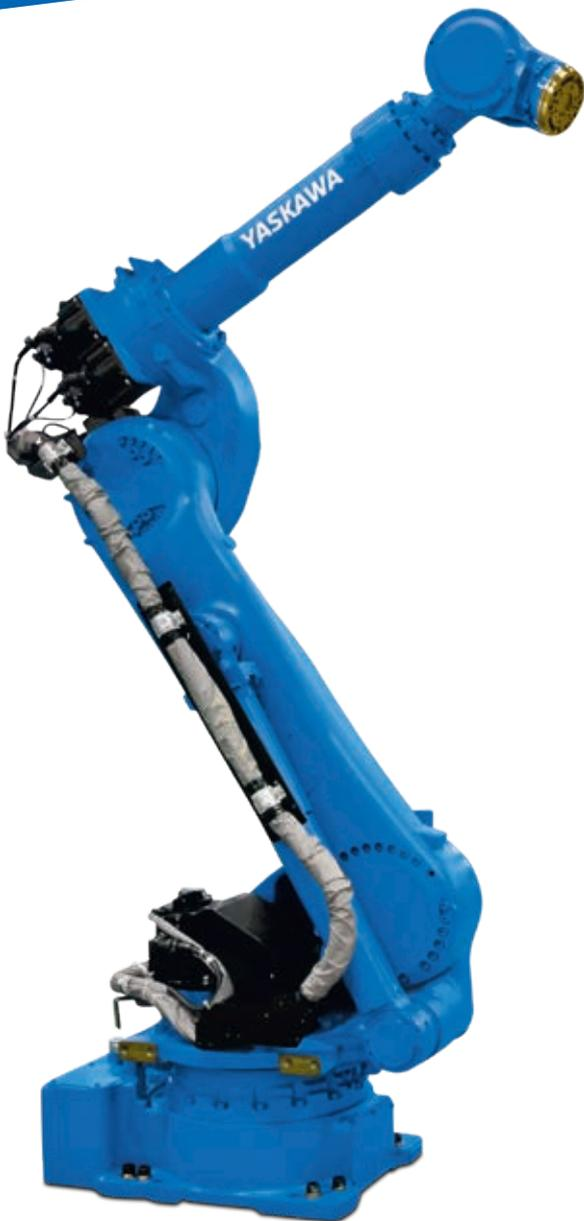
Der flexible 6-Achsroboter MOTOMAN GP180 bietet Höchstleistungen für eine Vielzahl von Applikationen, wie Handling, Maschinenbeschickung und Pressenverkettung.
